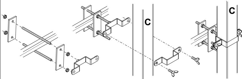
STAFFE PER PARAPETTO-MURO / PROFIL PFOSTENSCHELLE FÜR BRÜSTUNG-WAND / ETRIERS POUR PARAPET-MUR / PARAPET-WALL BRACKET / FIJACIÓN PARA PARAPETO/PARED.
