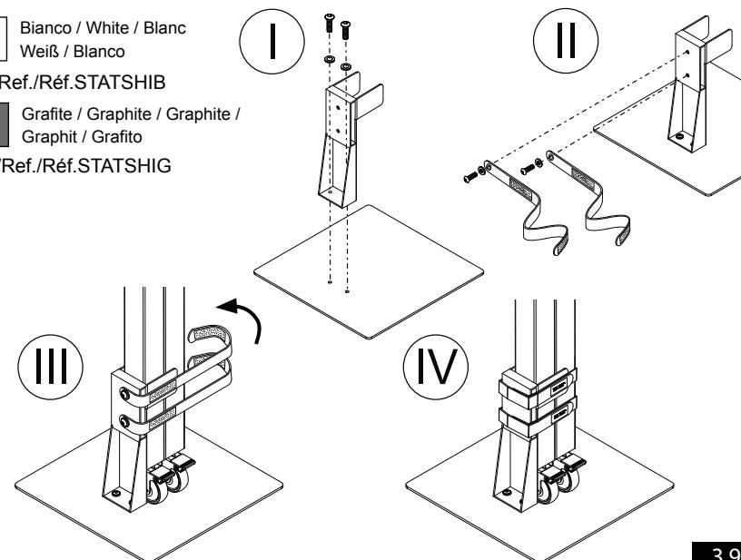
**IT****6) STAFFA REMOVIBILE PER POSIZIONAMENTO A TERRA STRUTTURA MOBILE**
