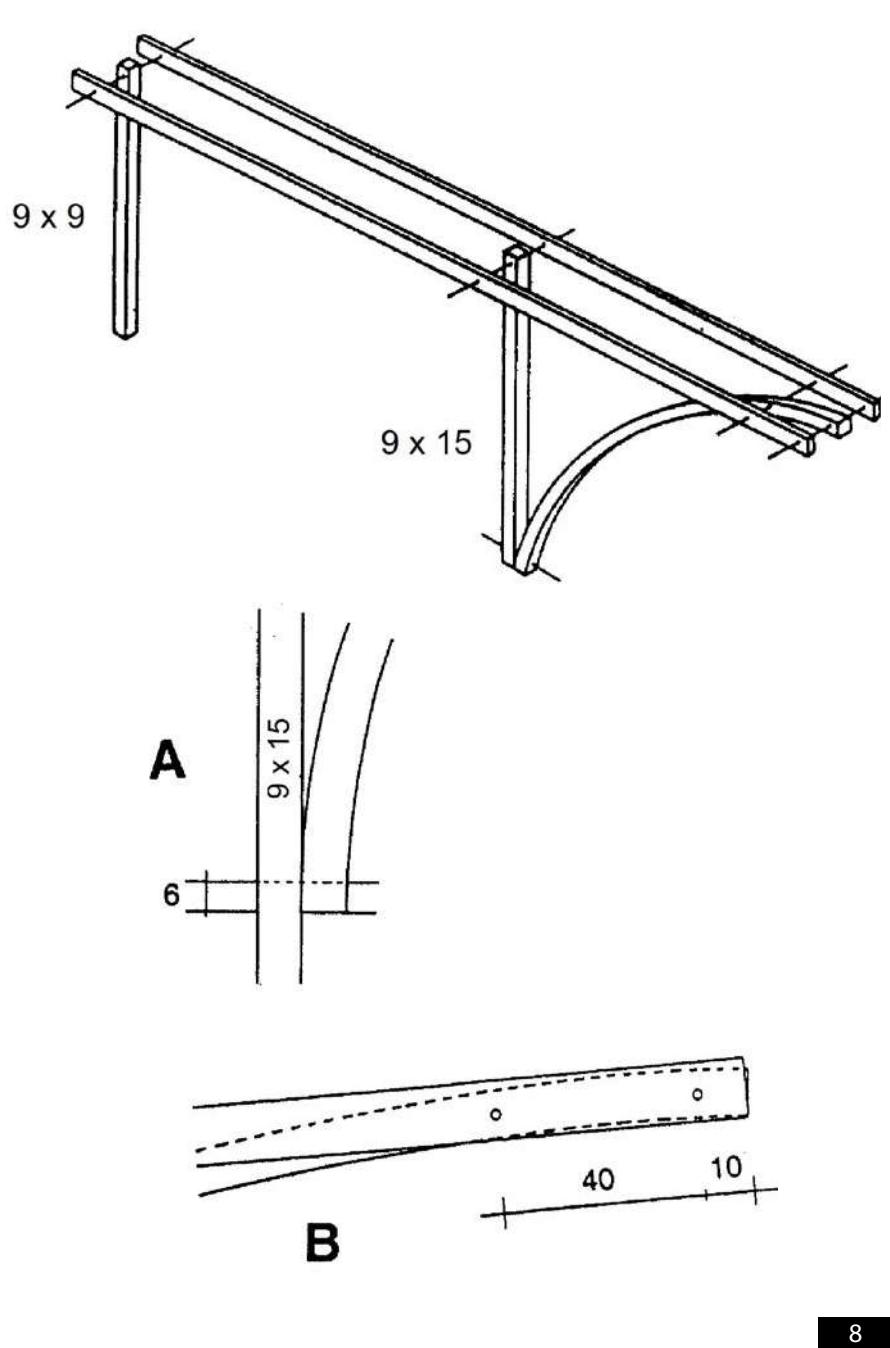
IT - Inserire i manicotti filettati mm 16/85 nei fori dei pilastri quindi, utilizzando rondelle dentate, rondelle piane e bulloni mm 12/90, fissare le relative travi di mm 60 x 150 come illustrato nel particolare A di figura 10. Posizionare l'arco bloccandolo con dei morsetti (fig.8) e forare al centro della trave alle distanze riportate nei particolari A e B di figura 8 utilizzando una punta Ø mm 16.
