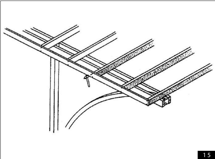
IT - Fissare la fascia di rifinitura laterale di sezione mm 27 x 117 utilizzando chiodi mm 2,7/60 (fig.15). La lunghezza della fascia del covercar COD45G è di cm 131.7 + cm 307.3 mentre per il covercar COD60G è di cm 253.9 + cm 314.5 (fig.16).
