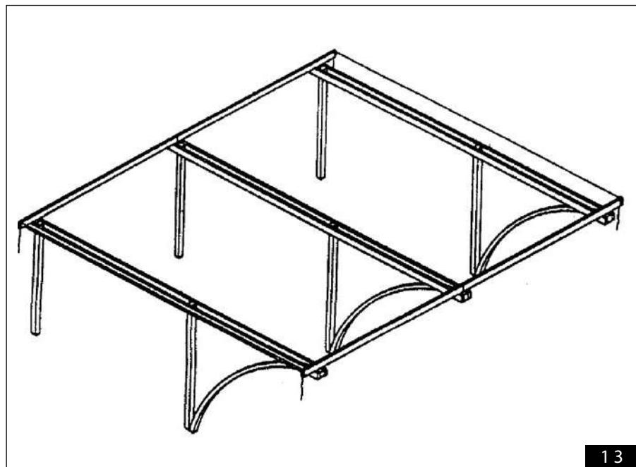
IT - Poggiare sulle travi portanti il primo e l'ultimo arcareccio lasciando un aggetto di cm 23,5 e segnare sugli arcarecci i punti di contatto con le travi portanti (fig.12, part.A). Riportare a terra gli arcarecci e forarli utilizzando una punta Ø mm 4 (fig.12, part.B) dopodichè fissare le staffe a cinque fori con un chiodo ad aderenza migliorata mm 6/60 (fig.12, part.C).
